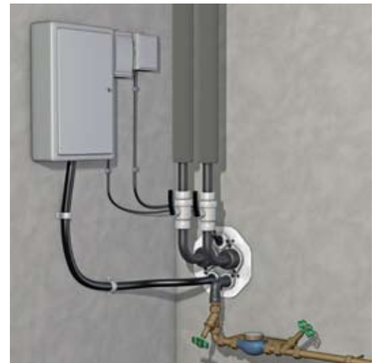
Mehrspartenhausanschluss mit Fernwärme
