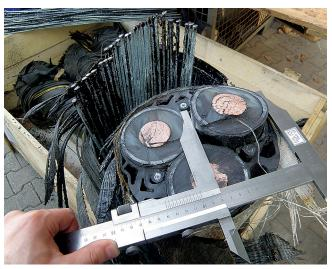
Seekabel mit sehr großen Durchmessern – typisch für Offshore-Anwendungen.
