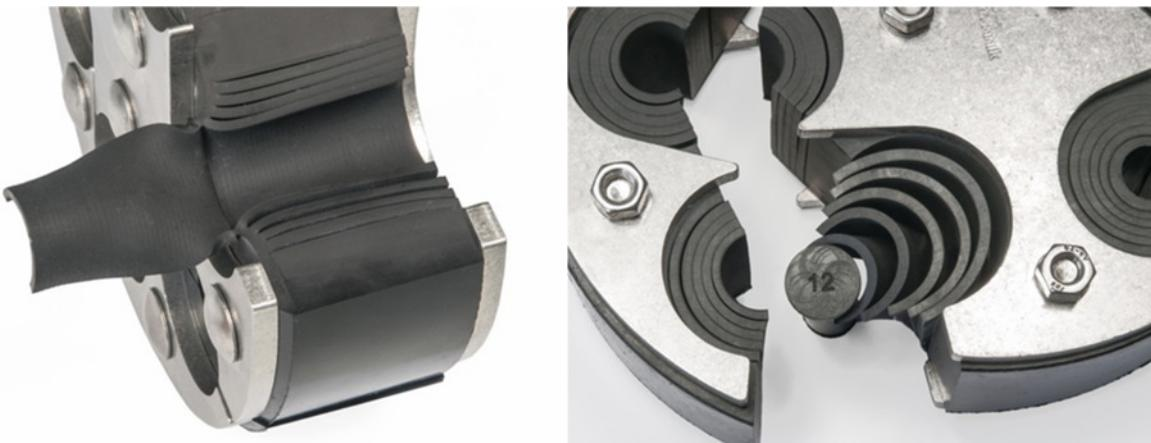
Za razliku od toga, brtve HRK-SSG oblikovani su dijelovi te imaju segmentne prstenove s naznakom točnog promjera, zbog čega pružaju još veću sigurnost pri primjeni i lakše se ugrađuju. Promjeri kabela koje je moguće zabrtviti utisnuti su izravno na pojedinačne segmente pa tako olakšavaju izbor segmenata. Plastične pritezne ploče koje se primjenjuju imaju integrirani zatvoreni spoj kojim se postiže dodatna prednost – potpuno se može isključiti usukavanje pri montaži.
