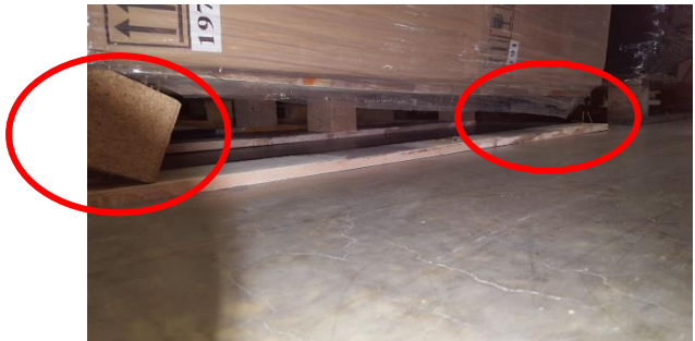
Abbildung 21: Palette – Beschädigung Klötze
