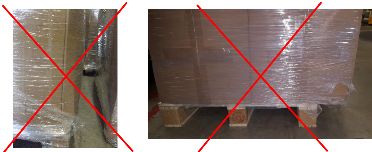
Abbildung 8: Nicht akzeptiert - Ausbeulen/Ausbauchen und generell Überstand
