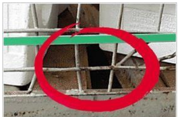
Abbildung 27: Gitterbox – Bretter beschädigt
