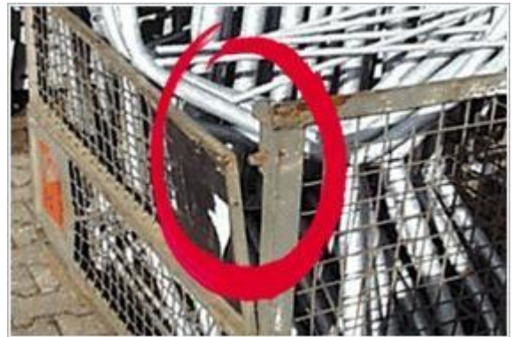
Abbildung 24: Gitterboxen – Klappen beschädigt
