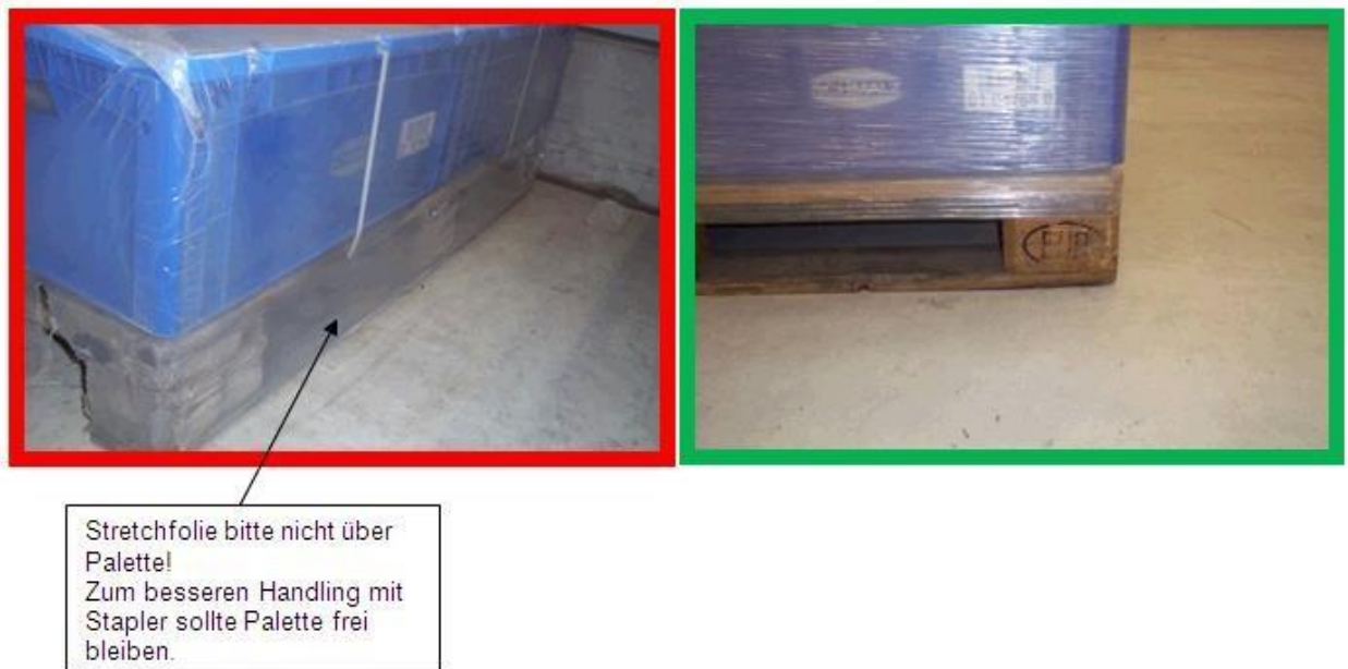
Abbildung 22: Umstretchung von Paletten
