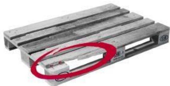
Abbildung 18: Palette – abgesplitterte Bretter
