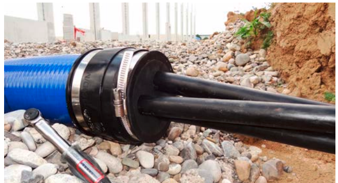
Abdichtung im Erdreich am Ende des Spiralschlauches Hateflex 14150 mit dem Abdichtset KES-M 150 WE 160-SG-3/22-54
