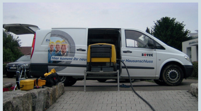
Bild 9: No-Dig-Fahrzeug mit eingebautem Kompressor
